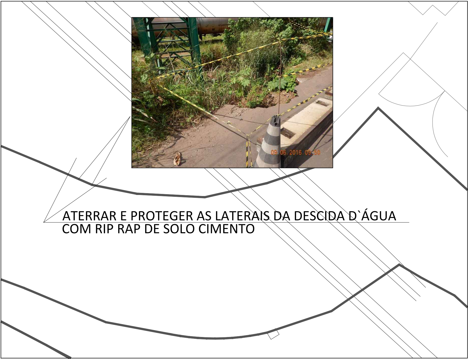
05 EROSIÃO PRÓXIMO A TRAVESSIA TEXACO ESC: 1/200
